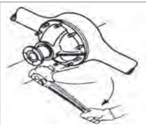
شکل ۵۶-۴ اعمال گشتاور مناسب هنگام بستن
