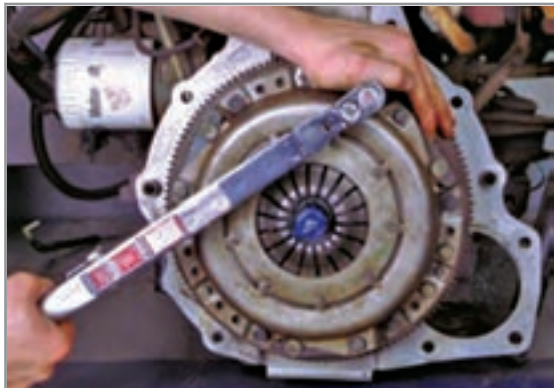
شکل ۳۹-۱ نحوه به گشتاور رساندن پیچ های دیسک کلاچ
