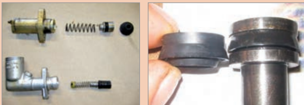
شکل ۲۱-۱- الف) نشتی داخلی در مدار هیدرولیکی
