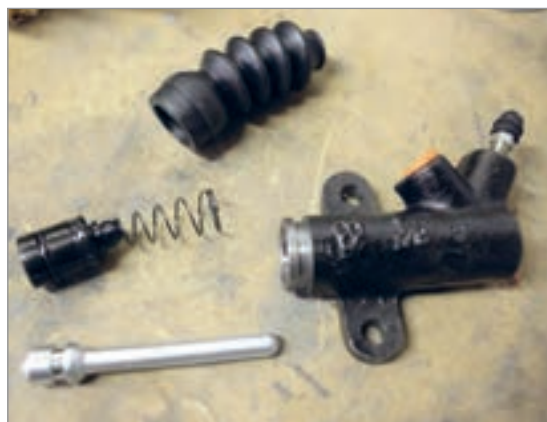
شکل ۱-۲۴- اجزای سیلندر اصلی کلاچ
