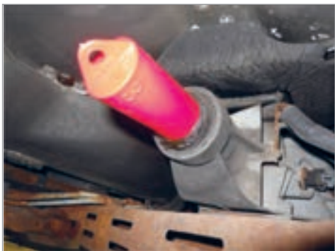
شکل ۳-۱۹- استفاده از ابزار مخصوص کورکن
