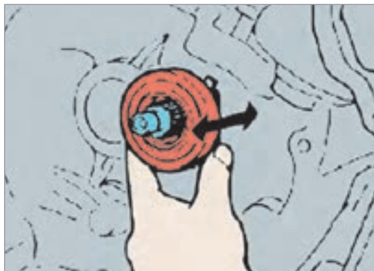
شکل ۴۰-۱ نحوه بررسی حرکت بلبرینگ کلاچ روی شفت کلاچ
