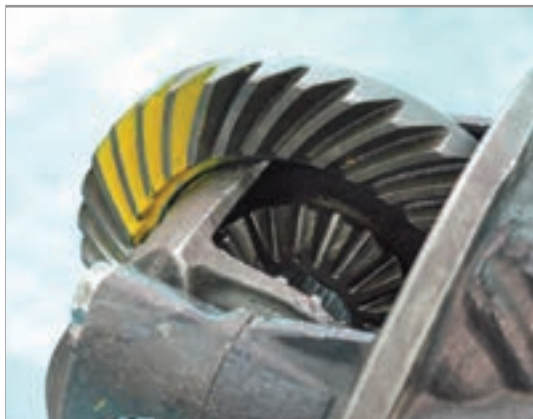
شکل ۴-۲۸- استفاده از رنگ برای کنترل
