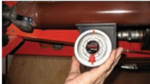
شکل ۳-۱۳- روش استفاده از زاویه سنج میل گاردان
