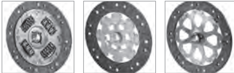
صفحه کلاچ با بدنه یکپارچه صفحه کلاچ با بدنه چند پارچه (انعطاف پذیر) صفحه کلاچ با فنرهای مارپیچ
