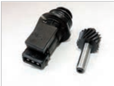
شکل ۲۲-۲ حسگر سرعت خودرو روی جعبه‌دنده
