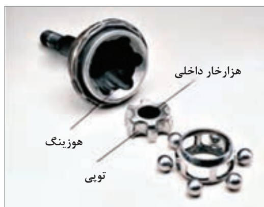
شکل ۵-۶- اجزای مفصل سرعت ثابت ساچمه ای از نوع ثابت
