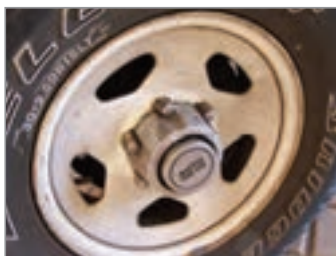
شکل ۵-۱- قفل روی چرخ (قفل پلوس) روی برخی خودروها
