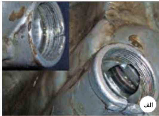
شکل ۲-۳۴- پوسته جعبه‌دنده و نحوه ترمیم آن
