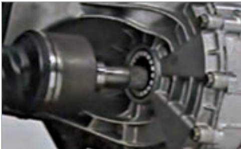
شکل ۱۹-۵ - خارج کردن پلوس با ابزار مخصوص
