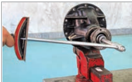
شکل ۴۸-۴- (ب) تعیین گشتاور پیش بار با گشتاورسنج
